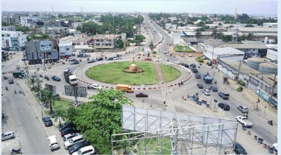
Avec un rayon giratoire de 40m, ce carrefour est classé parmi les grands giratoires. Avec une largeur de 12m pour l'anneau, et une voie d'entrée et de sortie de 10m ; ce giratoire est mal conçu et ne répondent pas normes de CEREMA. Il est retenu de :
