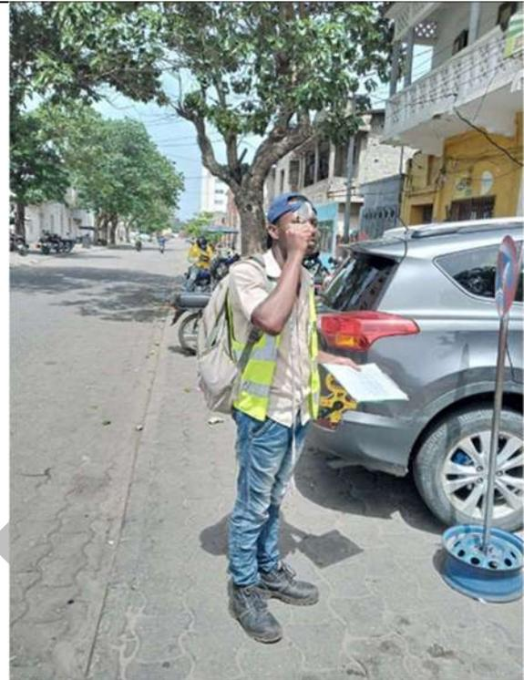
Photo 13: Prise de la hauteur des arbres au moyen d'un clinomètre.
